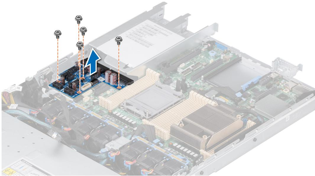
**Ilustración 1. Extracción de la tarjeta mediadora de alimentación**
