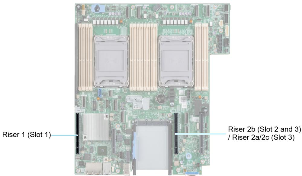
**Ilustración 2. Conectores de la ranura de tarjetas de expansión**
