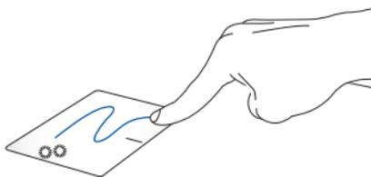
Doppeltippen Sie auf ein Element, wischen Sie dann mit demselben Finger, ohne den Finger vom Touchpad zu lösen. Legen Sie das Element an seinem neuen Ort ab, indem Sie Ihren Finger vom Touchpad lösen.
