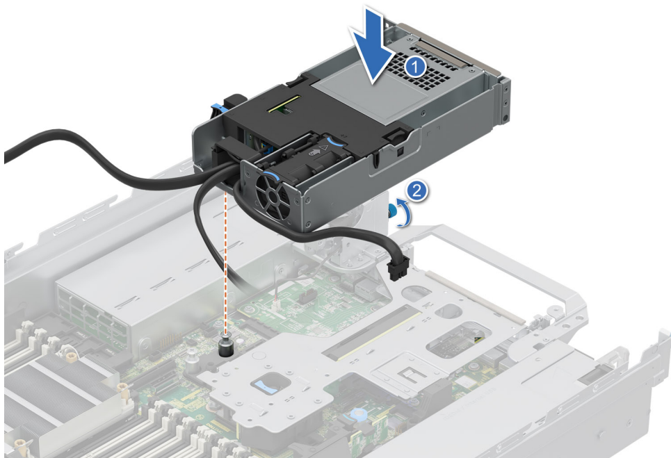
Abbildung 80. Einsetzen des hinteren 4 x EDSFF E3.S-Laufwerkmoduls
