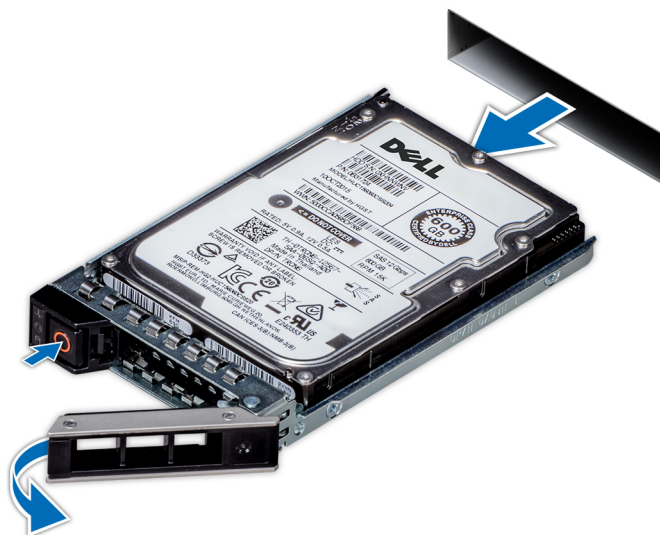
Abbildung 66. Entfernen eines Festplattenträgers
