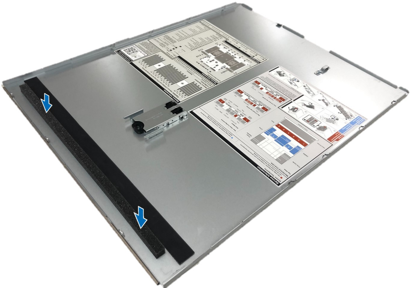
Figure 256. Installation de la mousse en Mylar sur le capot du système
