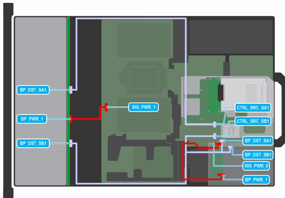
Abbildung 95. 12 x 3,5"-SAS/SATA mit APERC 11 in Riser 2 und 4 x 2,5"-SAS/SATA hinten
