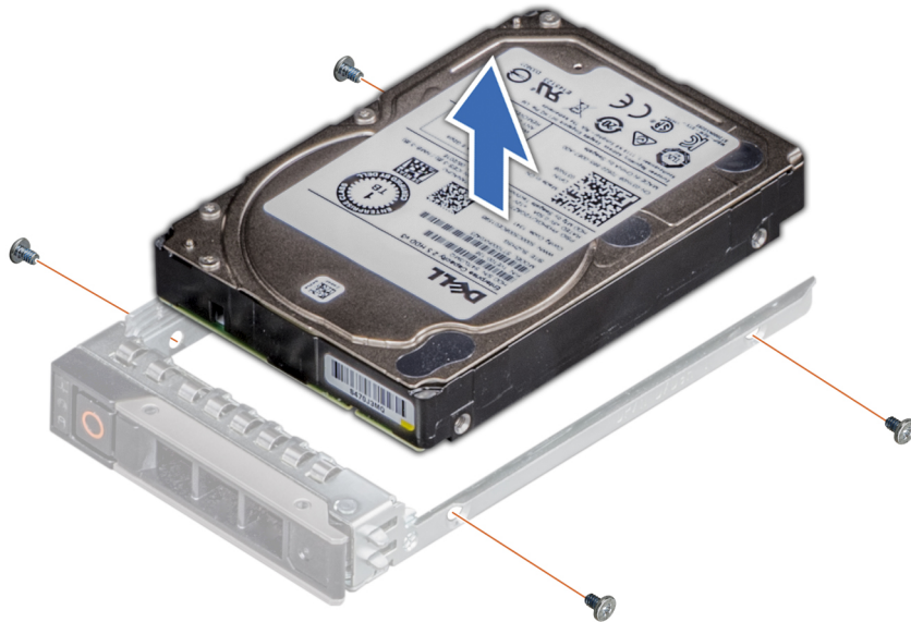
Abbildung 67. Laufwerk aus Laufwerkträger entfernen
