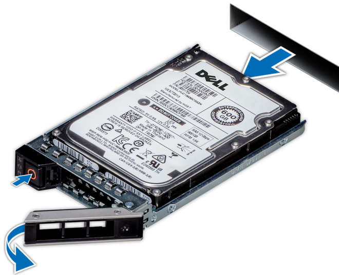
Abbildung 63. Entfernen eines Festplattenträgers
