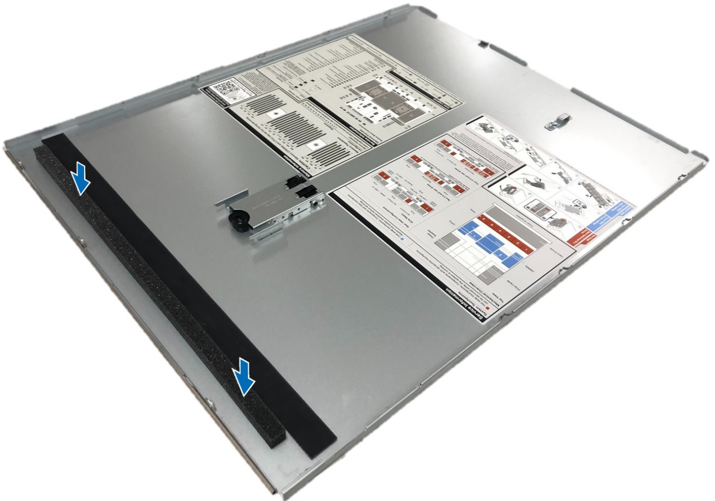
Abbildung 256. Anbringen von Mylar-Schaum auf der Systemabdeckung
