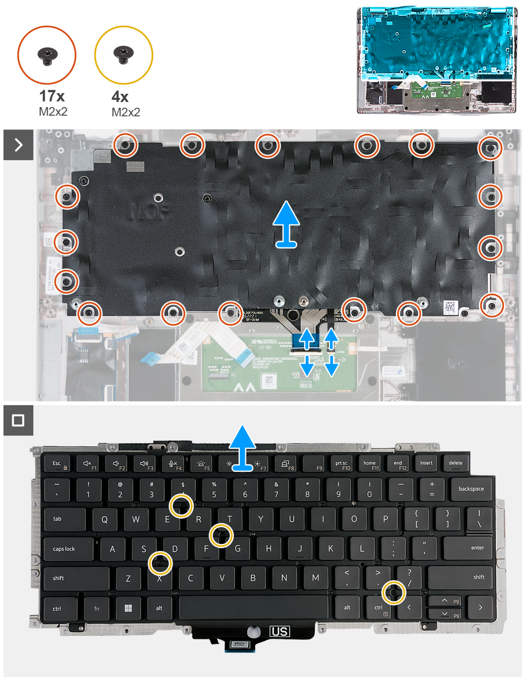
Obrázek 61. Demontáž klávesnice
