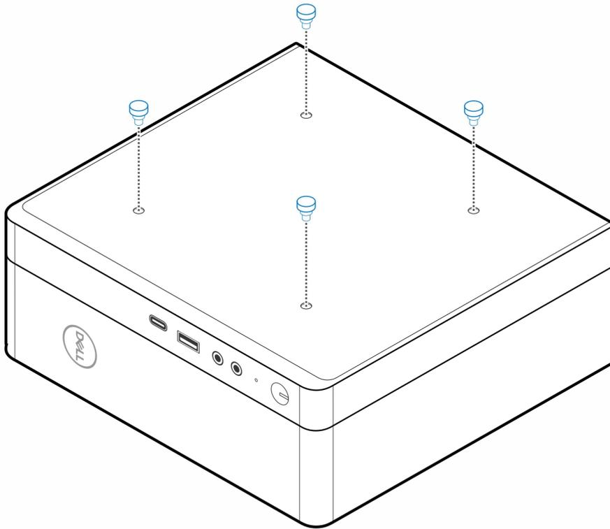
5. Richten Sie die Stellschrauben (M4x4) an den Kerben auf der Tischhalterung aus und montieren Sie den Computer auf der Tischhalterung.
