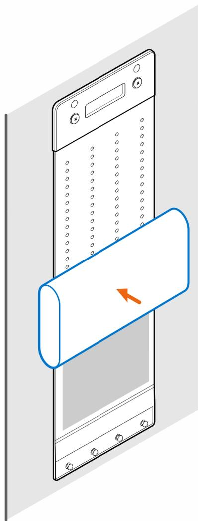
8. Wickeln Sie die Manschette um den Netzadapter und stecken Sie die Haltetaschen in die Löcher des Netzadapters auf der entsprechenden Höhe.
