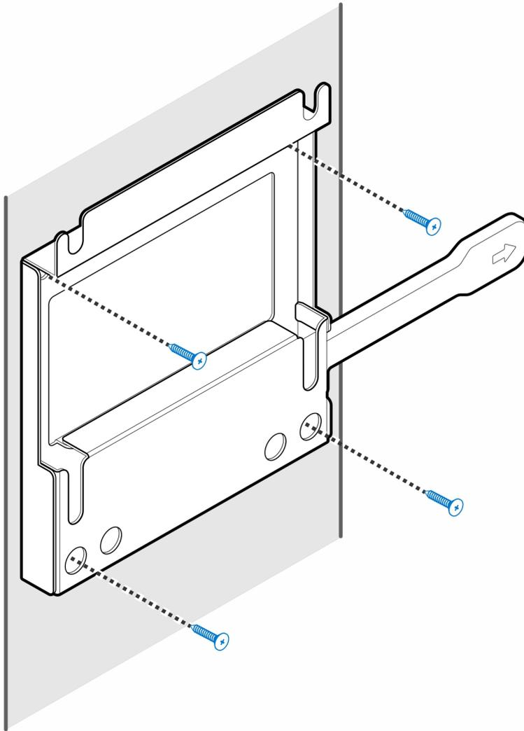
4. Bringen Sie die zwei Schrauben (M3x6) zur Befestigung der Netzadapterhülle an der VESA-Halterung an.
