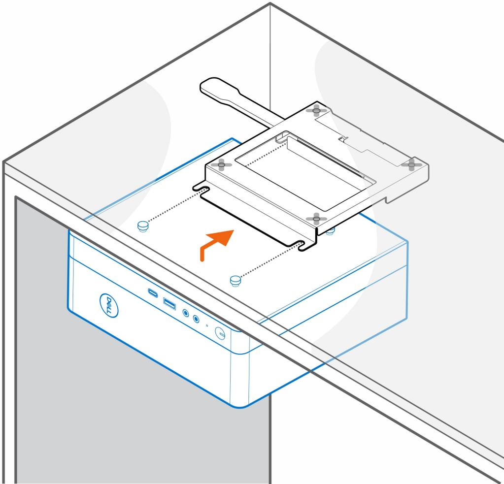
6. Setzen Sie die beiden Schrauben (M3x6) ein, mit denen der Netzadapter unter dem Schreibtisch befestigt wird.
