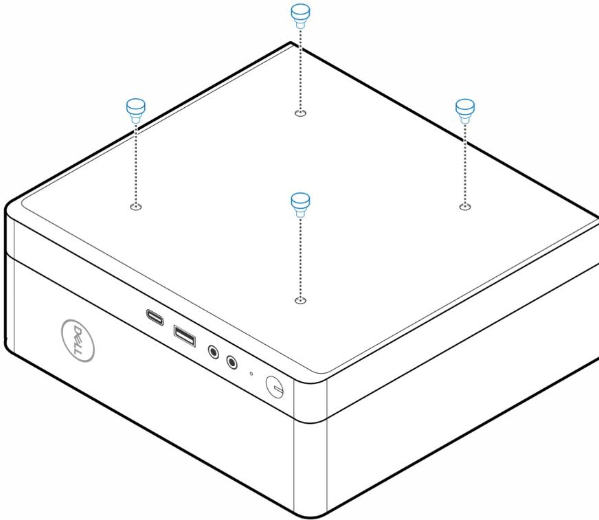
3. Richten Sie die Stellschrauben (M4x4) an den Kerben am All-in-One-Ständer aus und montieren Sie den Computer am All-in-One-Ständer.
