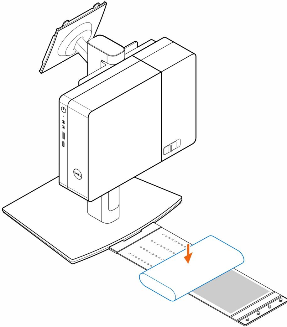
6. Wickeln Sie die Manschette um den Netzadapter und stecken Sie die Haltetaschen in die Löcher des Netzadapters auf der entsprechenden Höhe.
