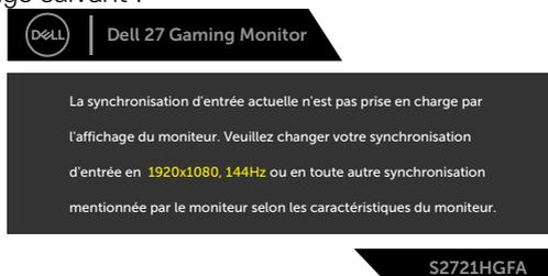
Cela signifie que le moniteur ne peut pas se synchroniser avec le signal qu'il reçoit de l'ordinateur. Consultez [Spécifications du moniteur](#) pour les plages de fréquences horizontales et verticales adressables par ce moniteur. Le mode recommandé est 1920 x 1080.
