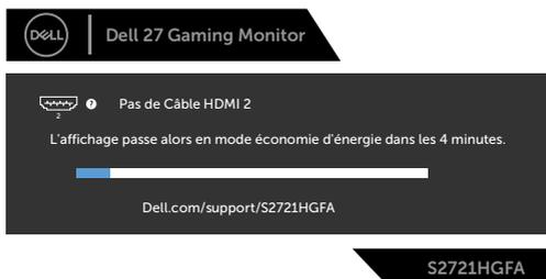
4. Cette boîte apparaît également pendant le fonctionnement normal du système si le câble vidéo est déconnecté ou endommagé.
