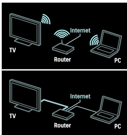
È possibile collegare questo televisore alla rete domestica mediante connessione cablata o wireless.
