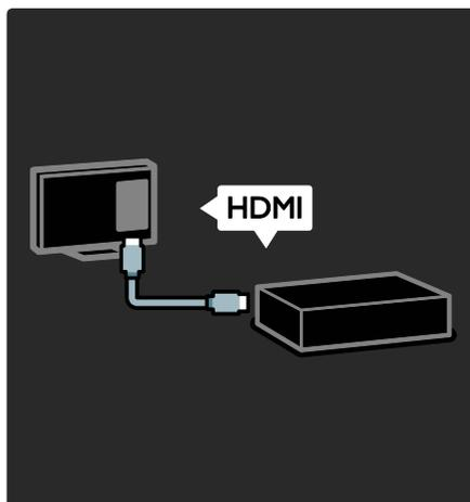
Per ottenere la migliore qualità video e audio, collegare un riproduttore di DVD, Blu-ray o una console di gioco tramite HDMI (TM).
