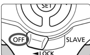
El selector de control remoto sirve para alternar entre disparo con flash normal y disparo con flash a distancia.
