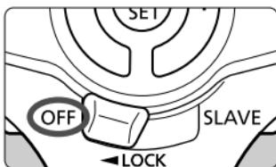
Le bouton de sélection sans fil permet de basculer entre la prise de vue avec flash normal et la prise de vue avec flash sans fil.
