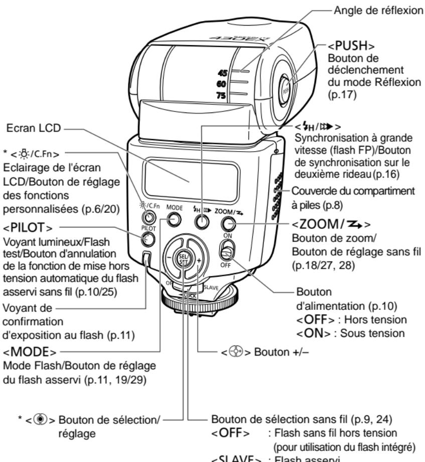
Les boutons indiqués par un astérisque possèdent un retardateur permettant que la fonction qu'ils commandent reste active pendant 8 s. (8s) une fois ces boutons relâchés. <Fn> s'éclaire pendant 12 s.
