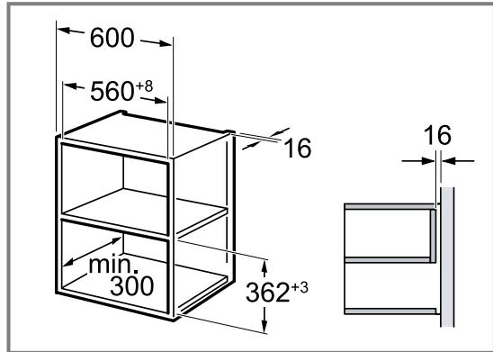
Encastrez l'appareil uniquement à une hauteur permettant de retirer sans problème les accessoires.
