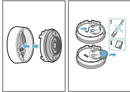
3. Inserire una nuova batteria, rispettando le indicazioni relative alla polarità. Utilizzare solo batterie di qualità di tipo CR2032.
