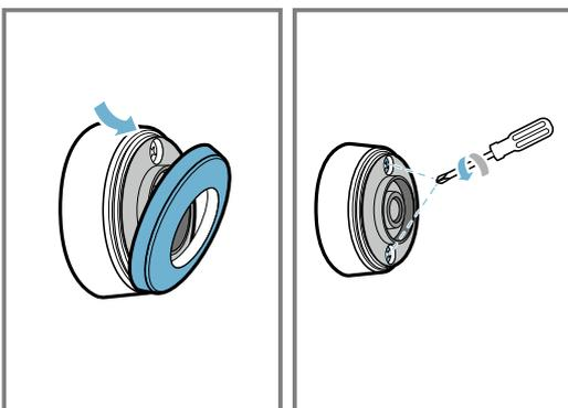
2. Aprire il coperchio del sensore di cottura e rimuovere la batteria dalla base.
