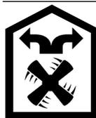
Per catturare gli odori nel funzionamento a ricircolo d'aria, è necessario installare un filtro antiodore. Le diverse possibilità di attivazione dell'apparecchio con funzionamento a ricircolo d'aria sono indicate nel catalogo o devono essere richieste al proprio rivenditore specializzato. Gli accessori necessari sono disponibili presso i rivenditori specializzati, tramite il servizio clienti o il punto vendita online.
