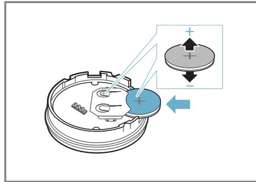
**Nota:** Non utilizzare oggetti in metallo per rimuovere la batteria. Non toccare i punti di contatto della batteria.
