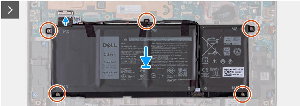
1. Allineare e ricollocare la batteria a 4 celle nello chassis del computer.
