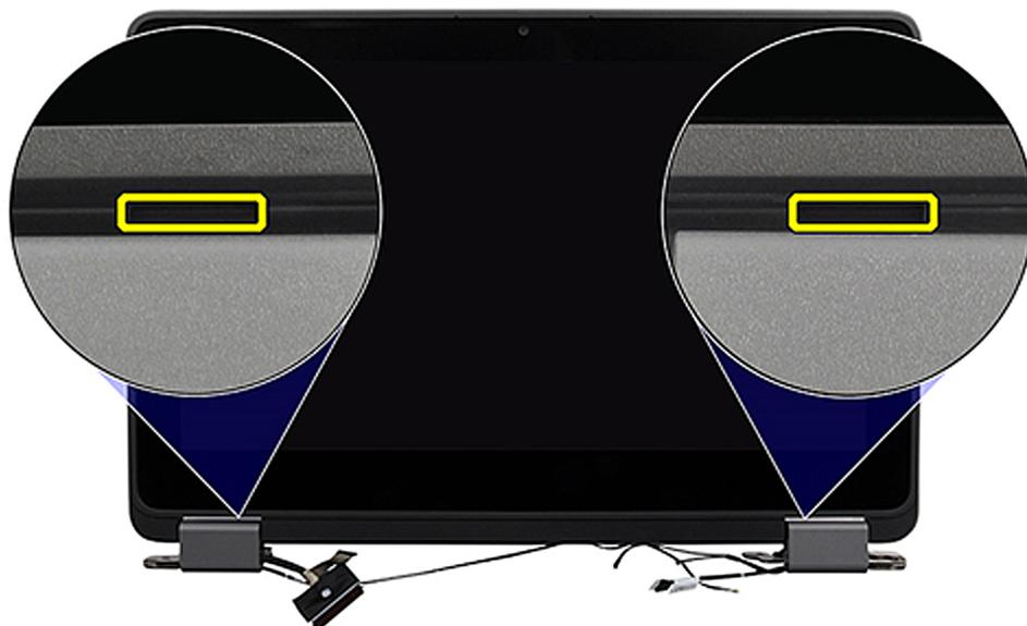
5. Regolare i cappucci delle cerniere del display a 90 gradi e le cerniere del display a 180 gradi in modo che il gruppo del display possa essere disteso sulla superficie.
