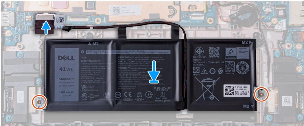
1. Allineare e ricollocare la batteria a 3 celle nello chassis del computer.
