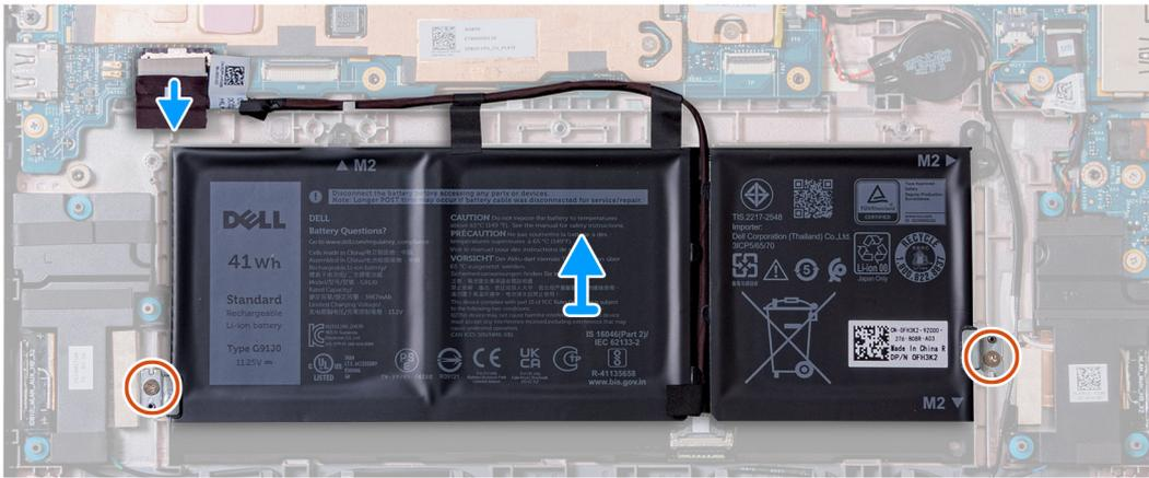
1. Rimuovere i nastri adesivi che assicurano la batteria a 3 celle allo chassis del computer.
