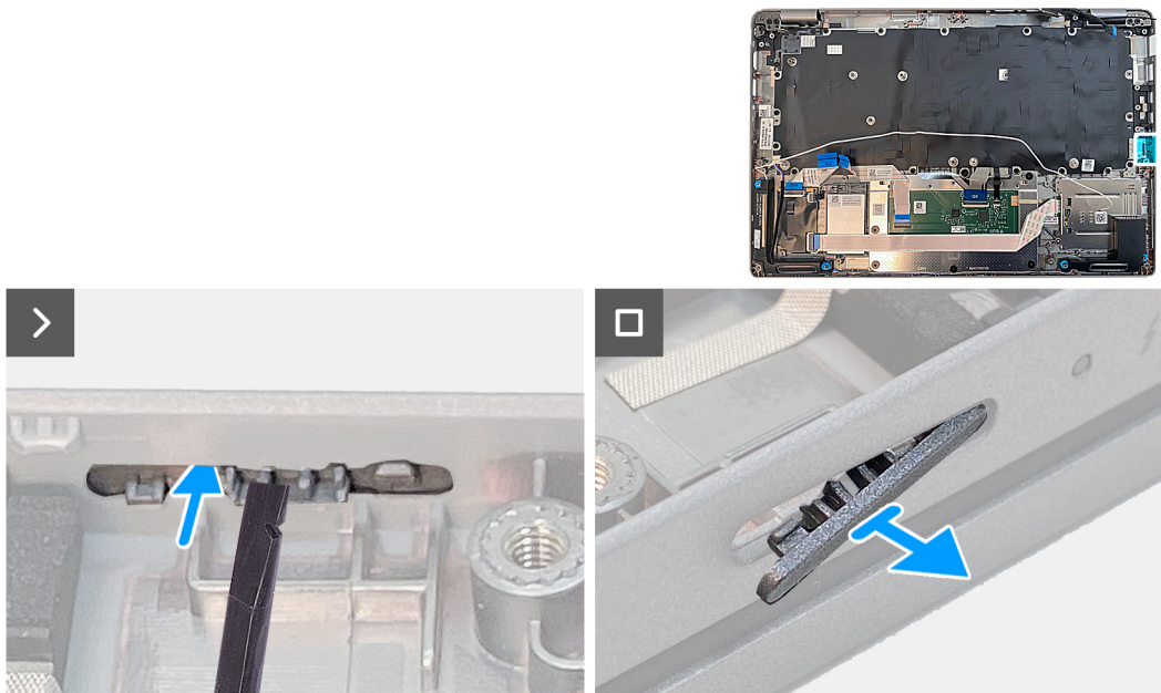
Ilustración 65. Extracción de la pieza de relleno de la ranura de tarjeta SIM ficticia
