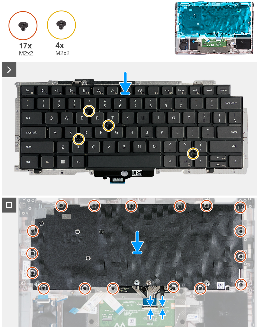
Ilustración 62. Instalación del teclado
