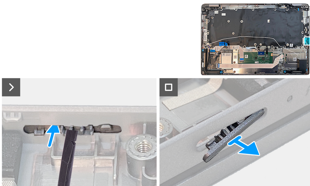
Afbeelding 65. De dummy simkaartslotvuller verwijderen
