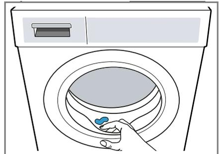
4. Die Gerätetür und die Waschmittelschublade offen lassen, damit Restwasser abtrocknen kann.
