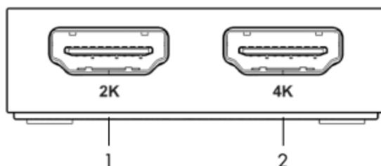
1. HDMI® Schnittstelle mit bis zu 2K@60 Hz
