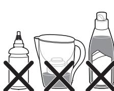
**Achtung: Verwenden Sie **kein** parfümiertes Wasser, Wasser aus dem Wäschetrockner, Essig, Wäschesteife, Entkalkungsmittel, Bügelzusätze, chemisch entkalktes Wasser oder andere Chemikalien, da dies zum Austreten von Wasser aus der Bügelsohle, braunen Flecken oder Schäden am Gerät führen kann.**
