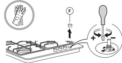
Une fois le réglage terminé, refaites le joint en utilisant une cire à cacheter ou un matériau équivalent.
