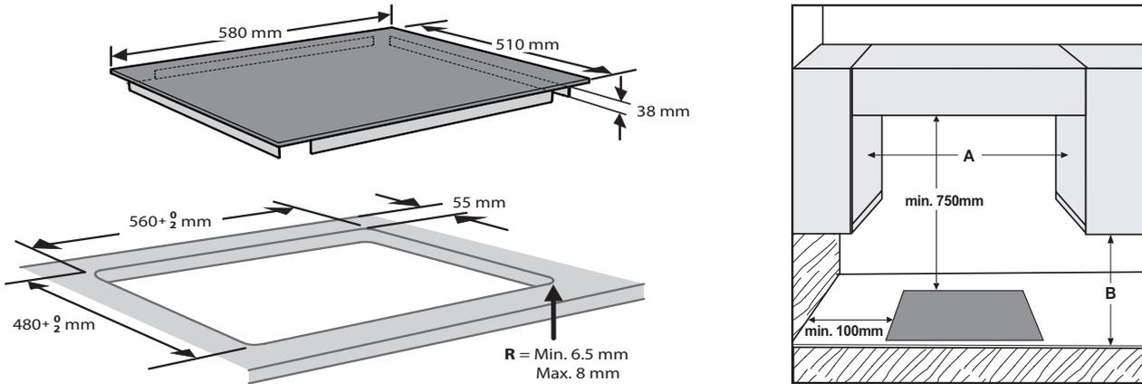
**REMARQUE:** si la distance "A" entre les éléments muraux est de 600mm à 730 mm, la hauteur "B" doit être au minimum de 530mm. Si la distance "A" entre les éléments muraux est supérieure à la largeur de la table de cuisson, la hauteur "B" doit être au minimum de 400 mm. Avant d'installer une hotte au-dessus de la table de cuisson, veuillez vous référer au manuel d'utilisation de la hotte qui spécifie les distances adéquates.
