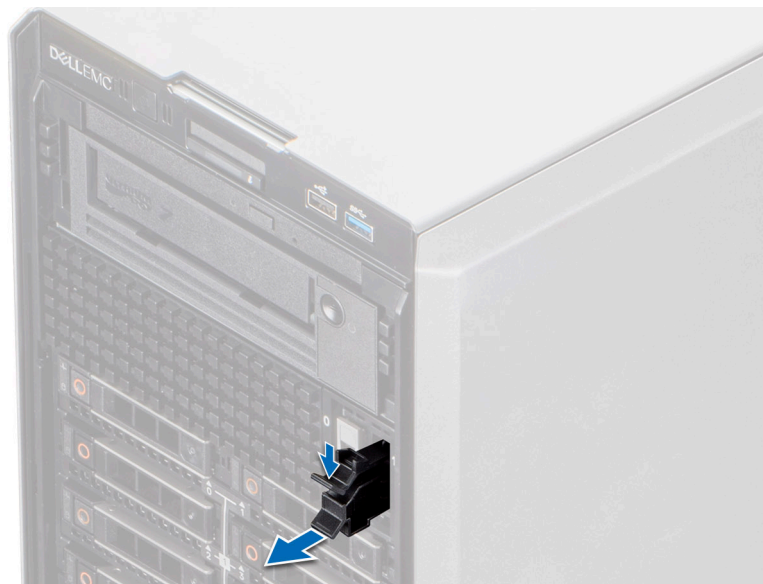
Abbildung 118. Entfernen des Platzhalters für den BOSS-S2-Kartenträger
