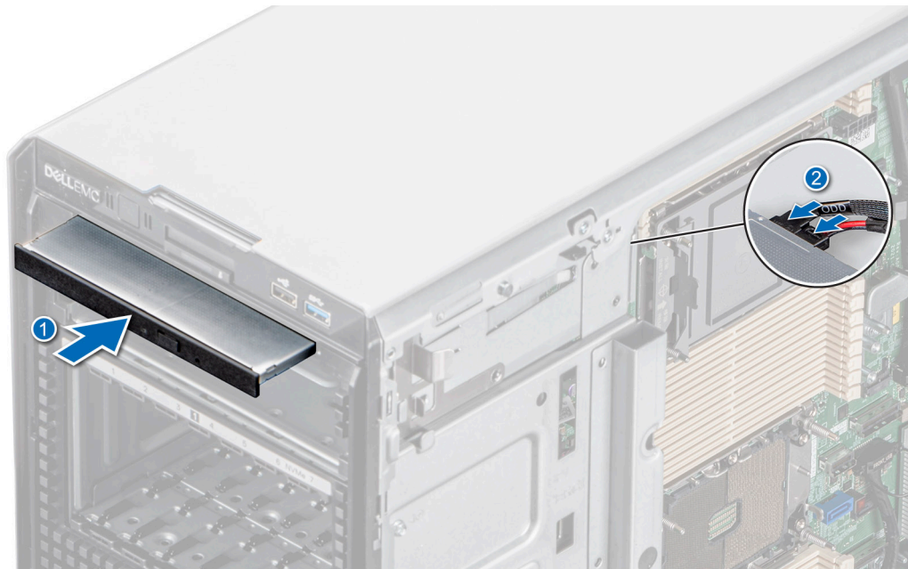
Abbildung 98. Installieren des optischen Laufwerks
