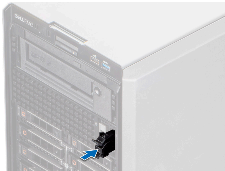
Abbildung 117. Einsetzen des Platzhalters für den BOSS-S2-Kartenträger
