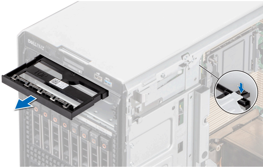
Abbildung 95. Entfernen des Platzhalters für das optische Laufwerk
