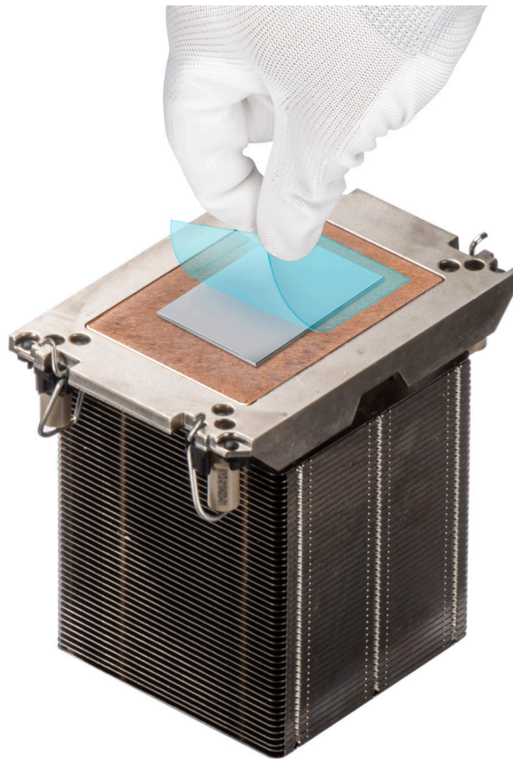
Abbildung 149. Entfernen der TIM-Schutzfolie (Thermal Interface Material)
