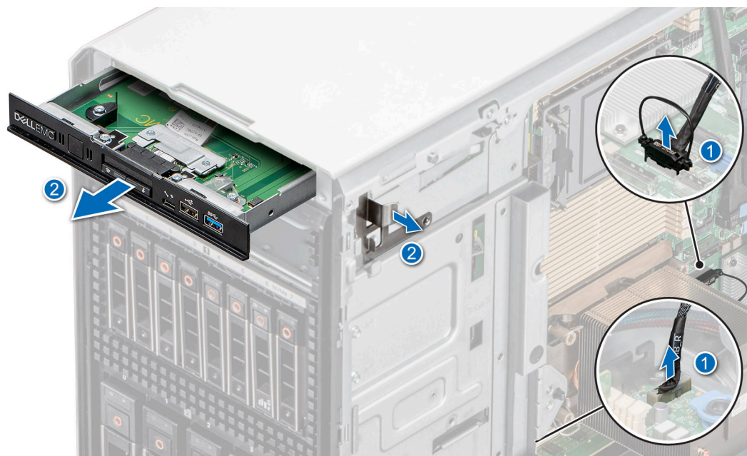
Abbildung 104. Entfernen des vorderen E/A-Moduls für die Upsell-Konfiguration
