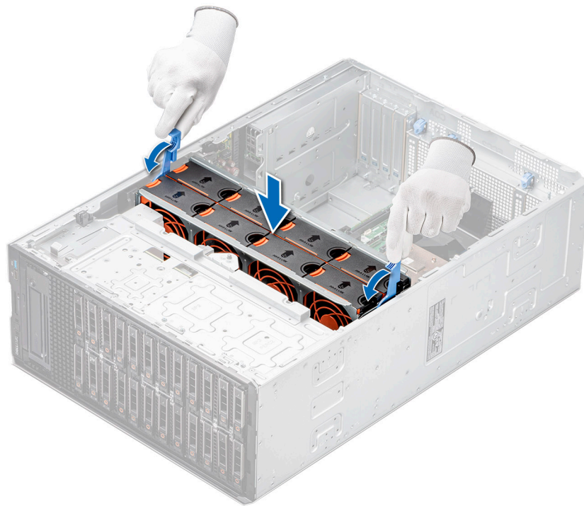
Abbildung 40. Installieren des Gehäuses des Lüfters
