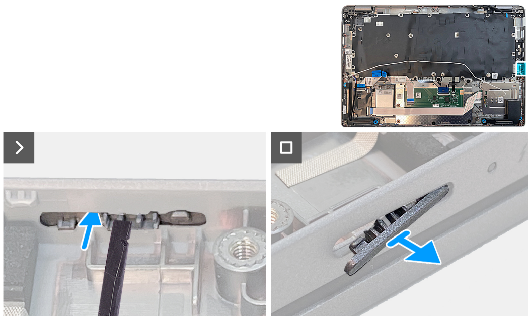
Abbildung 65. Entfernen des SIM-Karten-Platzhalters
