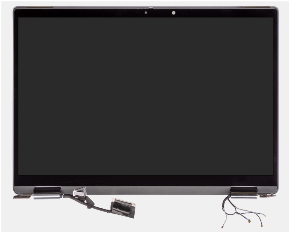
Abbildung 1. Bildschirmbaugruppe ohne WWAN-Antennenkabel
