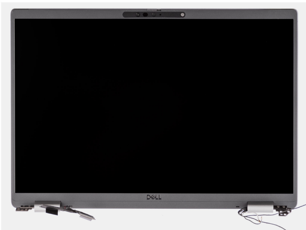
Abbildung 2. Bildschirmbaugruppe mit WWAN-Antennenkabeln
