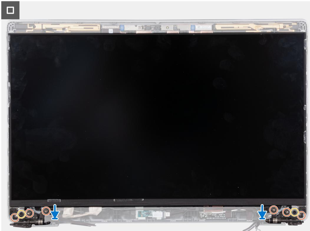
4. Bringen Sie die zwei Schrauben (M2x2,5) zur Befestigung des Bildschirms an der Bildschirmbaugruppe wieder an.
