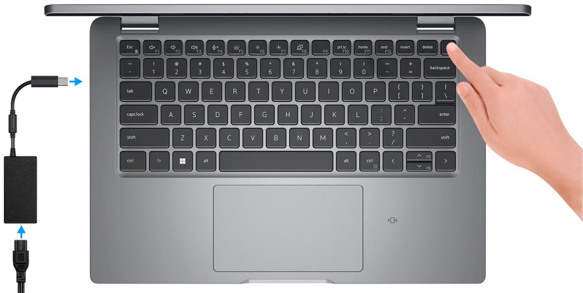
**ANMERKUNG:** Um Energie zu sparen, wechselt der Akku möglicherweise in den Energiesparmodus. Schließen Sie den Netzadapter an und drücken Sie den Betriebsschalter, um den Computer einzuschalten.
