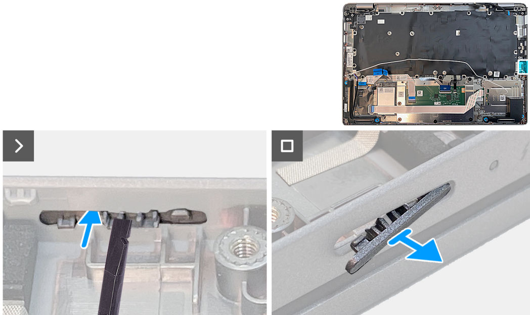
Figure 65. Retrait de la plaque de recouvrement du logement de carte SIM factice
