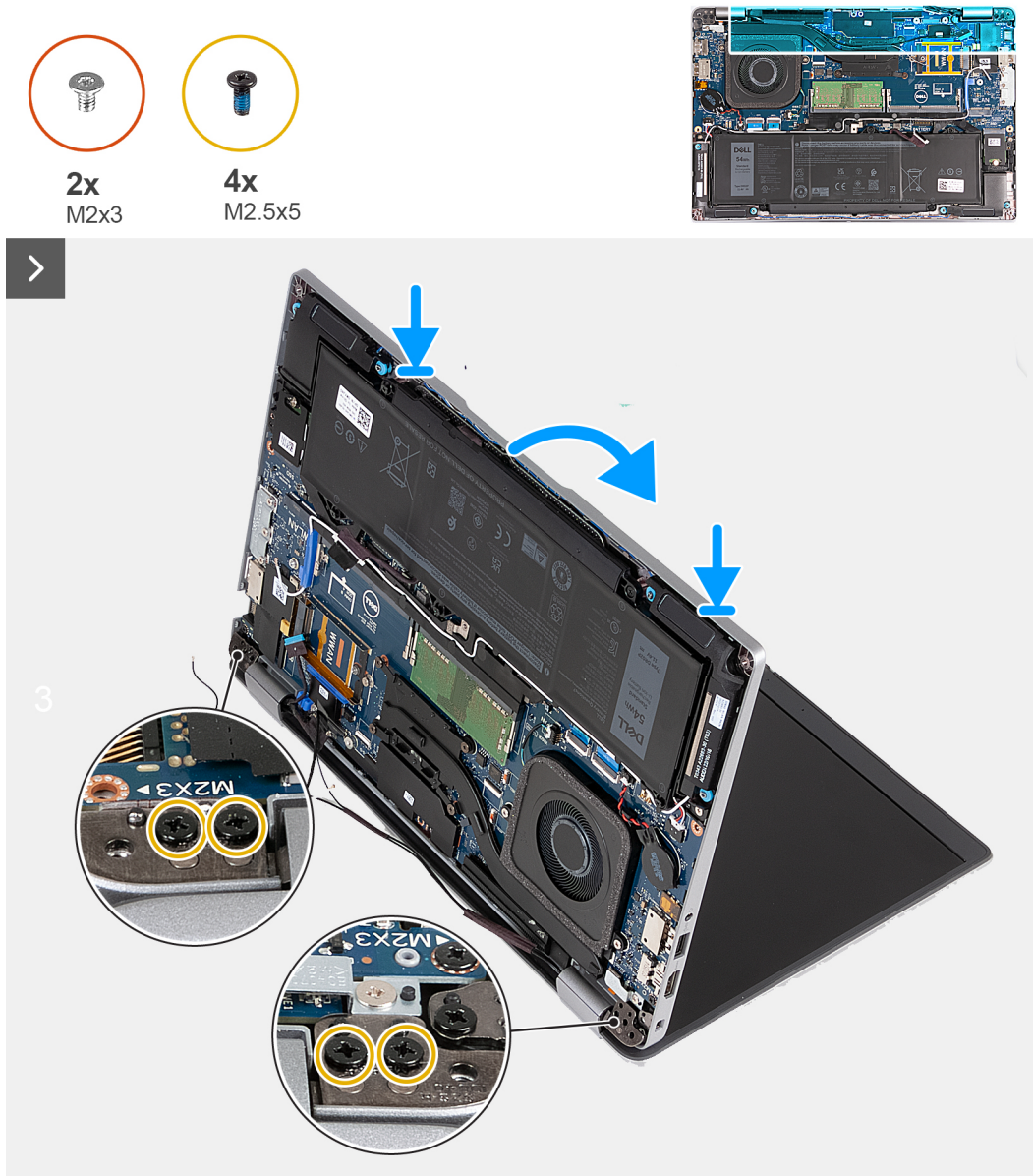
Figure 39. Installation de l'assemblage d'écran (pour les ordinateurs expédiés avec une carte 5G)
