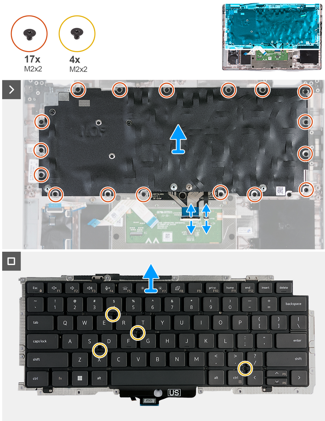
Figure 61. Retrait du clavier
