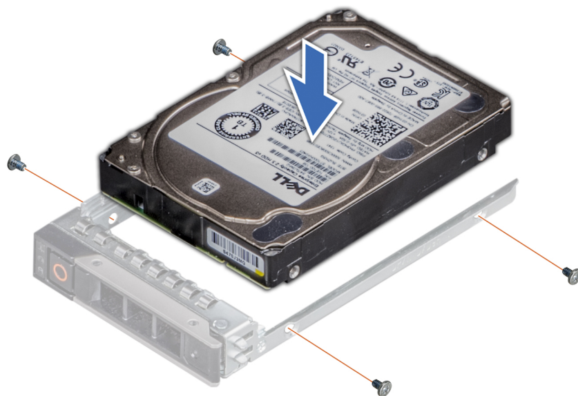
Abbildung 57. Einsetzen eines Laufwerks in den Laufwerksträger
