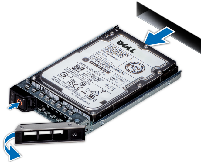
Abbildung 51. Entfernen eines Festplattenträgers
