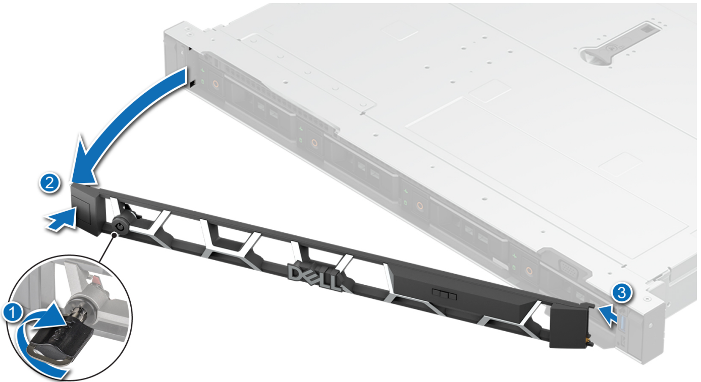
Abbildung 29. Entfernen der Frontverkleidung
