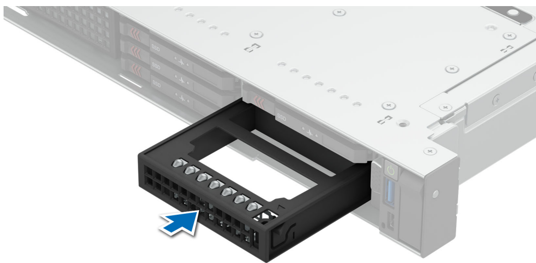
Figure 49. Installation d'un cache de disque
