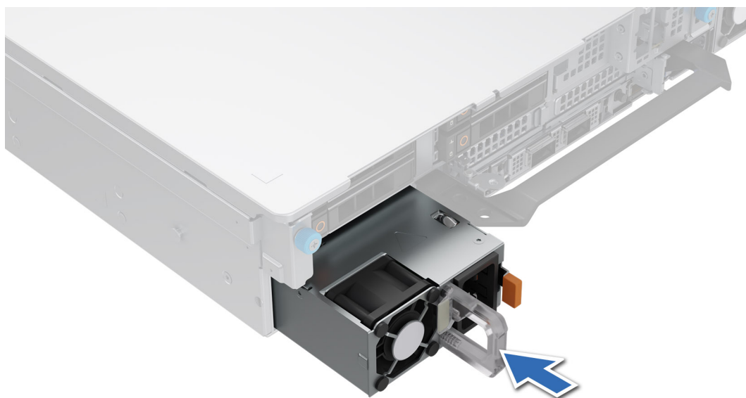
Figure 178. Installation d'un bloc d'alimentation
