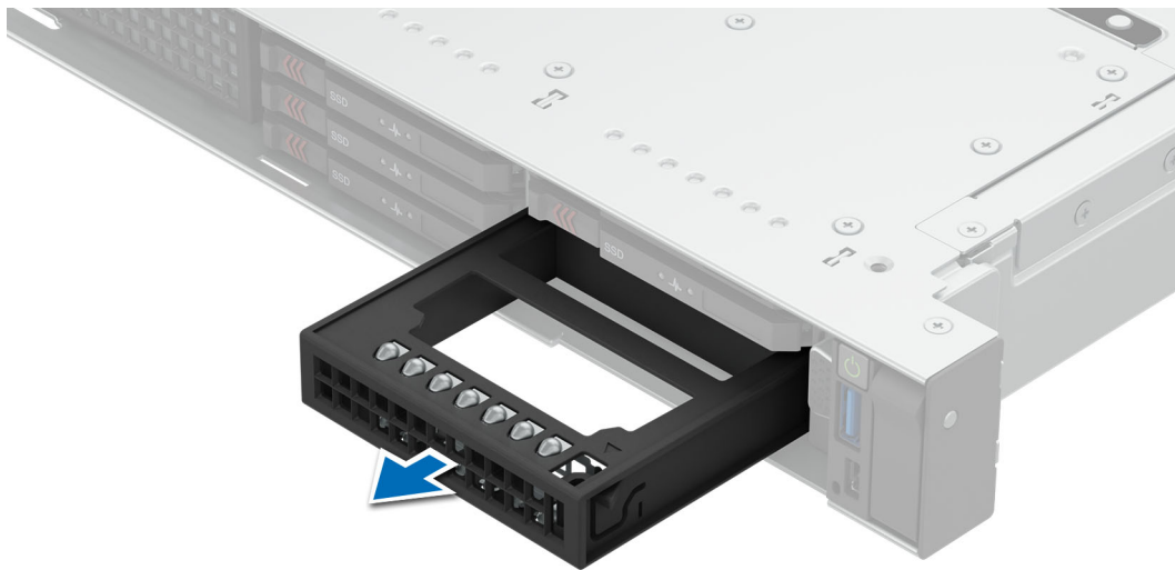
Figure 47. Retrait d'un cache de disque
