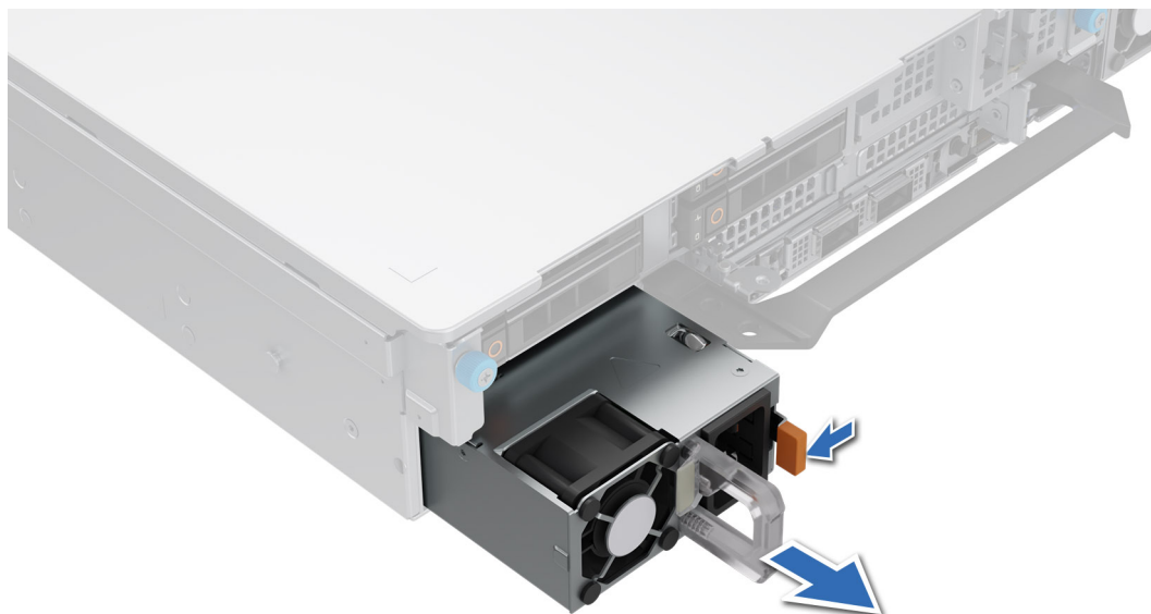
Figure 177. Retrait d'un bloc d'alimentation
