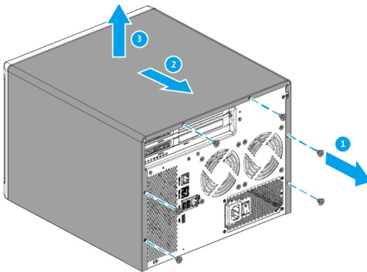
**5. Entfernen Sie die PCIe-Abdeckung.**
