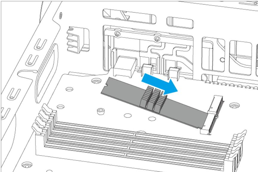
**c.** Setzen Sie den Steckbolzen ein, um das Laufwerk zu befestigen.
