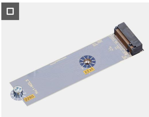
En la imagen a continuación, se indica la ubicación de la unidad de estado sólido M.2280 y se proporciona una representación visual del procedimiento de instalación.
