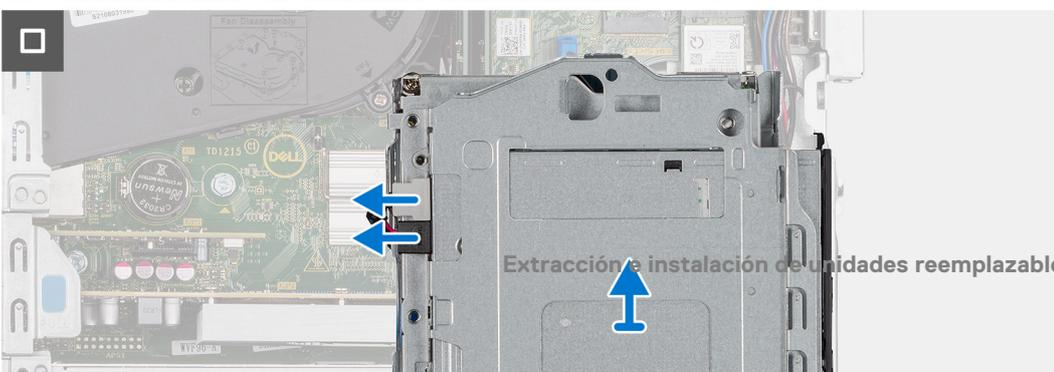
Extracción e instalación de unidades reemplazables por el cliente (CRU)
