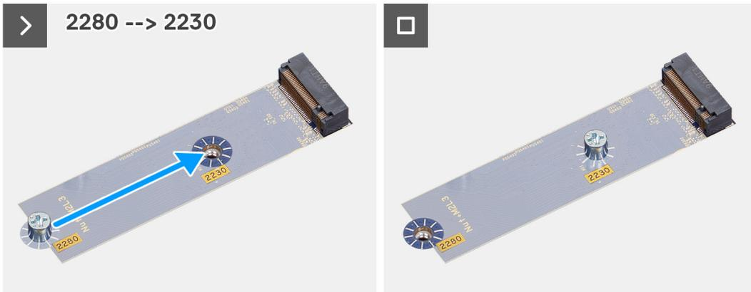
En la imagen a continuación se indica la ubicación de la unidad de estado sólido M.2230 y se proporciona una representación visual del procedimiento de instalación.
