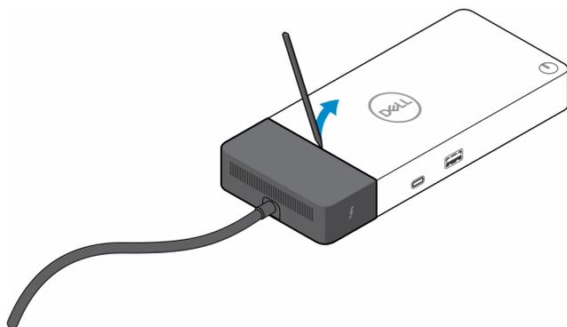
4. Mueva suavemente y quite el módulo del cable USB Type-C del conector dentro de la estación de acoplamiento.
