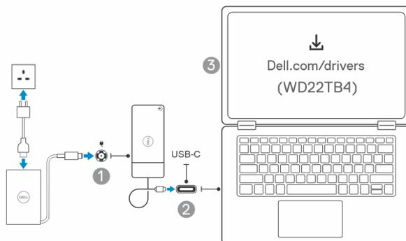
3. Conecte el conector USB Type-C al sistema.
