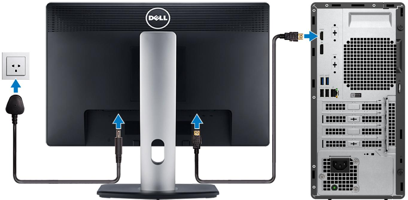
**i** **NOTA:** Si se realizó el pedido del equipo con una tarjeta de gráficos discretos, el puerto HDMI y los puertos de visualización en el panel posterior de la computadora estarán cubiertos. Conecte la pantalla al puerto de la tarjeta de gráficos discretos.
