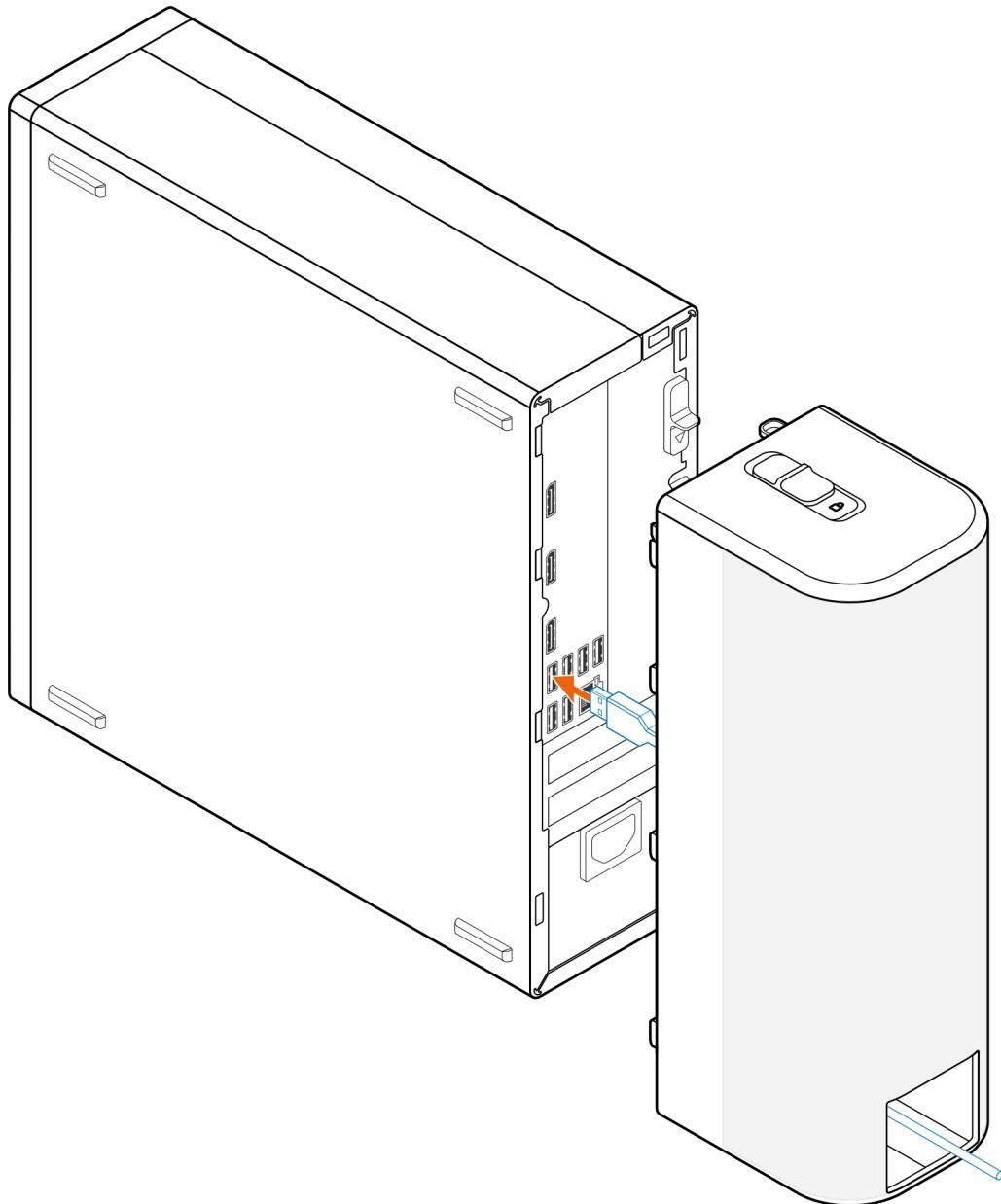
4. Alinhe os ganchos de retenção da cobertura de cabos com as ranhuras no chassis.
