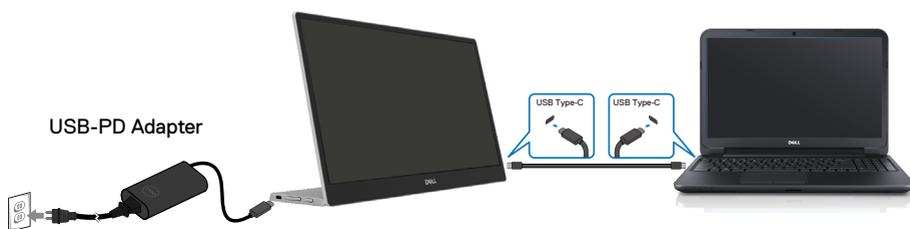
2. Ligue o transformador Tipo C ao P1424H e ligue o P1424H ao telemóvel com cabo USB Tipo C.
