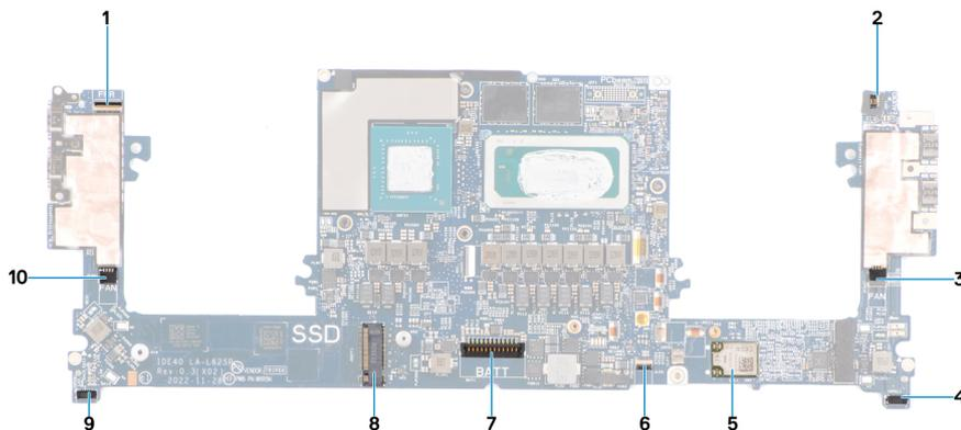
1. Conector do FPC do botão de alimentação com leitor de impressões digitais
