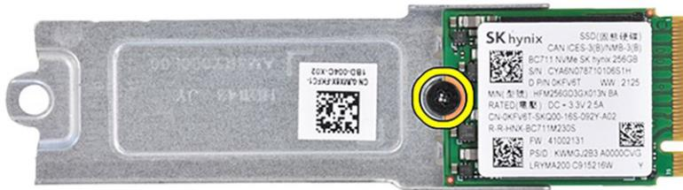
2. Volte a colocar o parafuso (M2x2) que fixa o disco de estado sólido M.2 2230 ao seu suporte.
