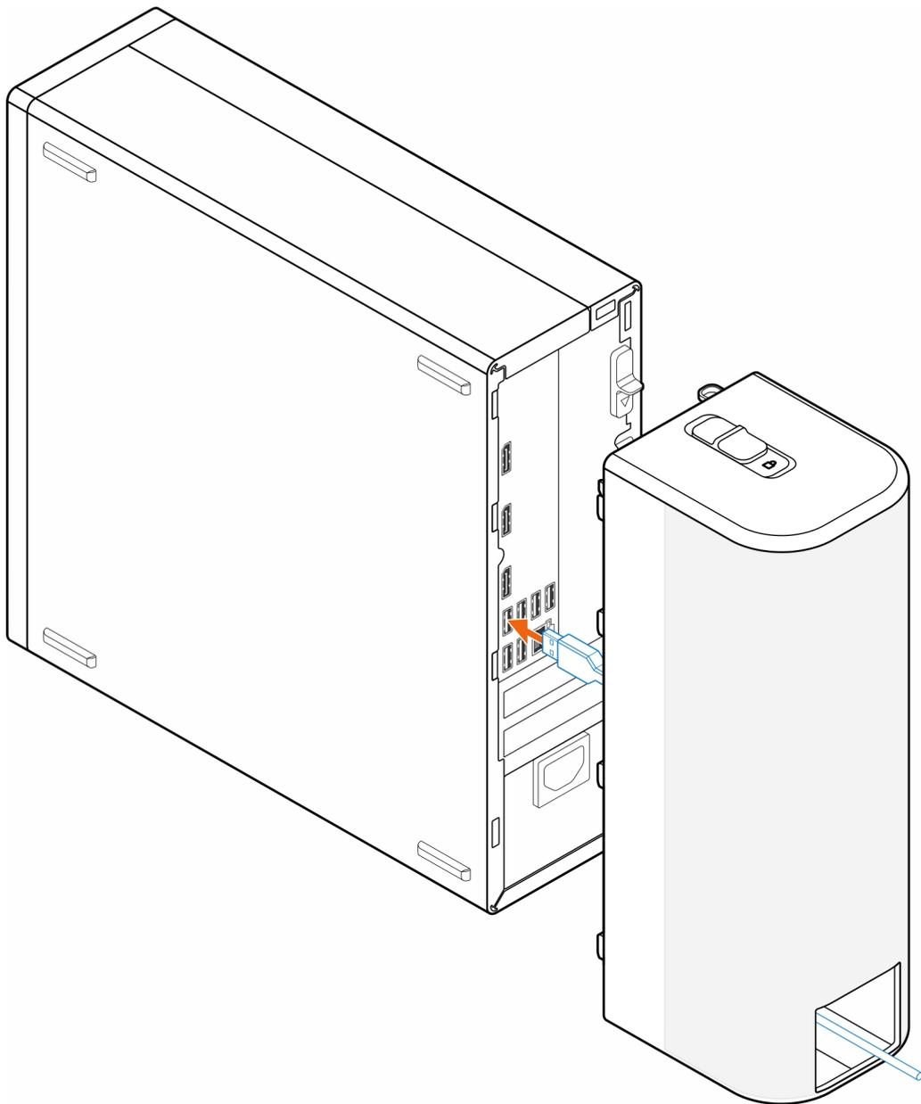
4. Alignez les crochets de fixation de la gaine de câble avec le logement sur le boîtier.
