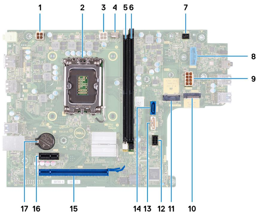
1. conector do cabo de alimentação ao processador (ATX CPU1)
