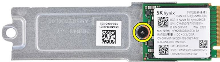
2. Ricollocare la vite (M2x2) che fissa l'unità SSD M.2 2230 alla staffa dell'unità SSD M.2 2230.
