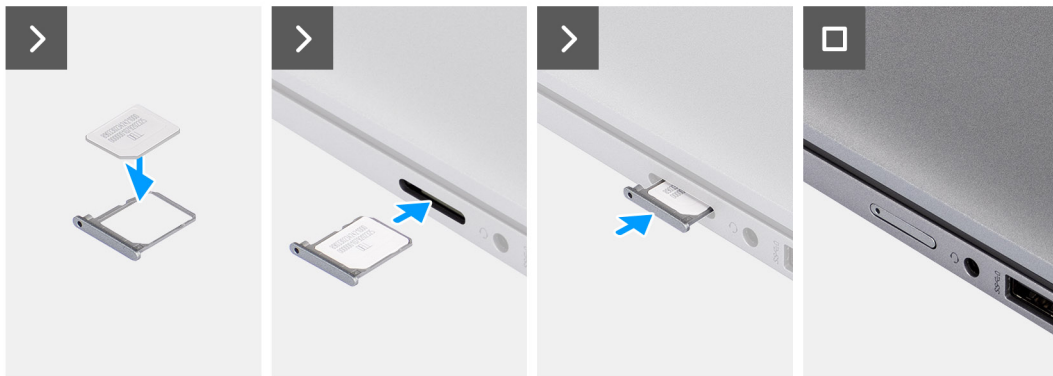
Ilustración 3. Instalación de la bandeja para tarjeta SIM
