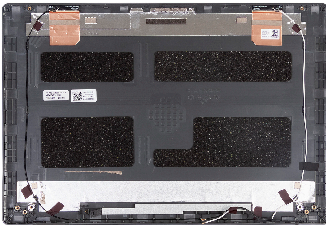
Figura 51. Rimozione del gruppo coperchio posteriore del display e antenna
