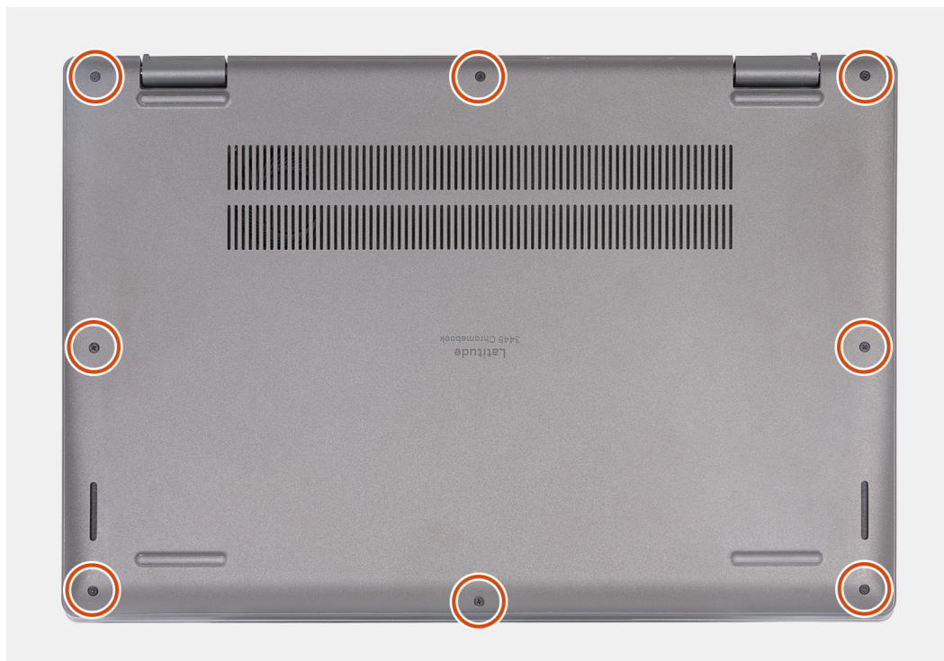
Figura 1. Rimozione del coperchio della base
