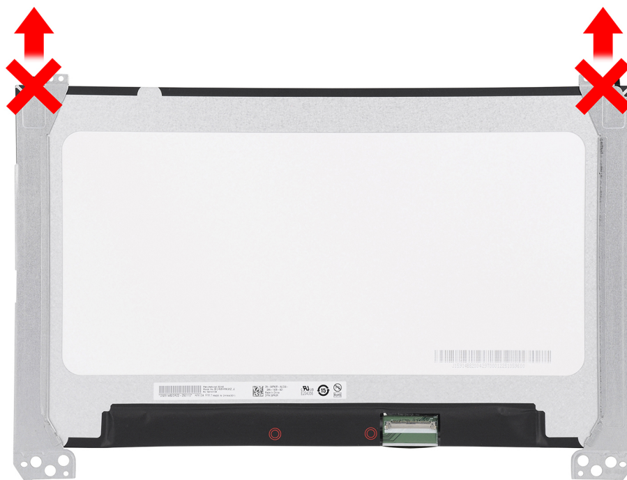
Figura 39. Rimozione del pannello di visualizzazione
