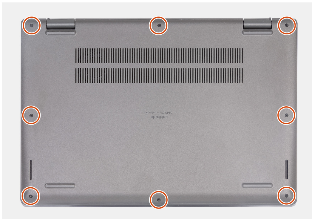
Figura 8. Installazione del coperchio della base
