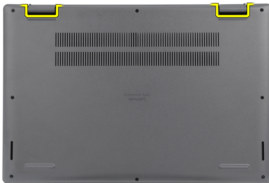
Figura 4. Rimozione del coperchio della base
