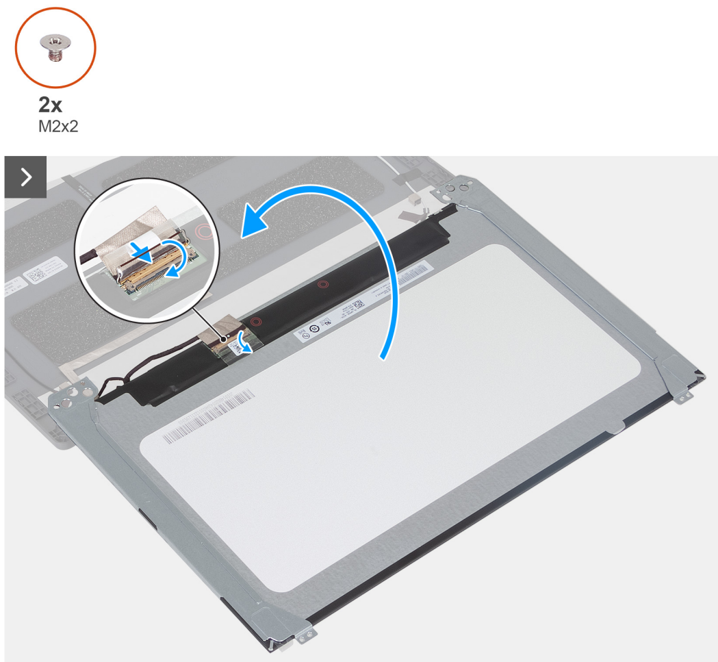
Figura 40. Installazione del pannello di visualizzazione
