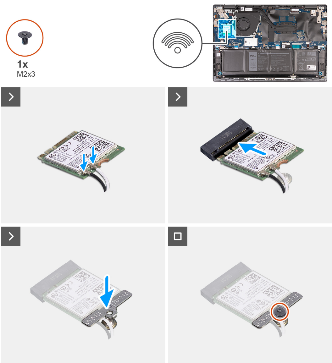
Figura 12. Installazione della scheda wireless
