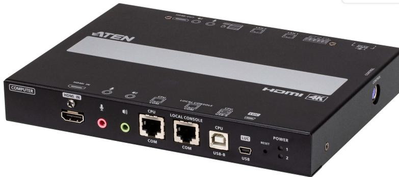
Lo switch KVM over IP HDMI a porta singola RCMHD101U è un dispositivo KVM progettato esclusivamente per applicazioni in linea di produzione, in grado di garantire l'accesso a video, audio, mouse e tastiera e ai media virtuali di una workstation in linea di produzione a console locali e remote per una comoda gestione. Supporta inoltre microfono e altoparlanti per le console locali e remote.
