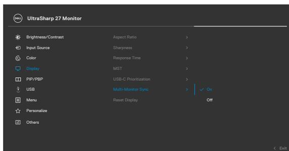
Se o Monitor 2 suportar a Sincronização Multimitores, a sua opção MMS será automaticamente definida para **On (Ligado)** também para a sincronização.
