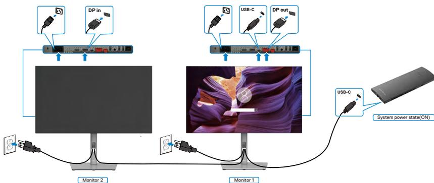
De igual forma, um PC está ligado a dois monitores num estado de energia inicialmente LIGADO, e o estado de energia do sistema informático está sincronizado com o botão de ligar do Monitor 1. Quando prime o botão de ligar do Monitor 1 ou do PC, tanto o Monitor 1, como o PC, se desligam. Entretanto, o Monitor 2 estará em modo de Suspensão. Terá de premir manualmente o botão de ligar do Monitor 2 para desligá-lo.
