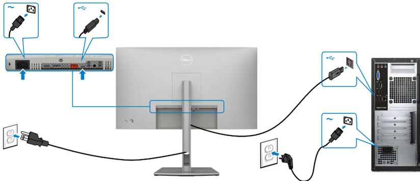
**REMARQUE:** Cette connexion ne contient que des données et aucune vidéo. Il faut une autre connexion vidéo pour l'affichage.
