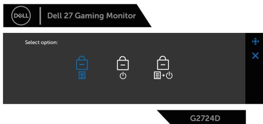
Para acessar ao menu Unlock (Desbloqueio), mantenha pressionado o botão 5 durante quatro segundos. Será exibido um menu Unlock (Desbloqueio) no canto inferior direito do ecrã.
