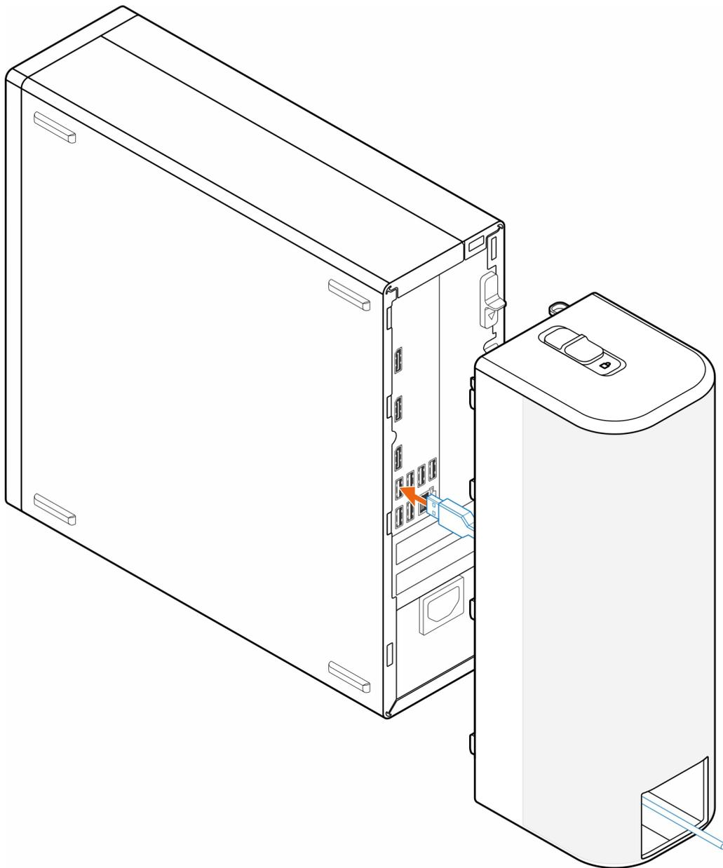
4. Richten Sie die Sicherungshaken der Kabelabdeckung auf die Aussparungen am Gehäuse aus.
