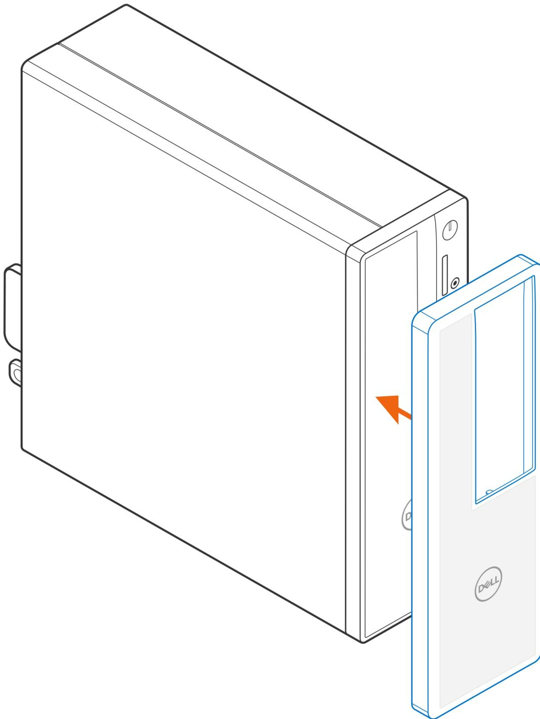
3. Drücken Sie vorsichtig auf die untere Kante des Staubfilters, um ihn über dem Computer zu schließen.
