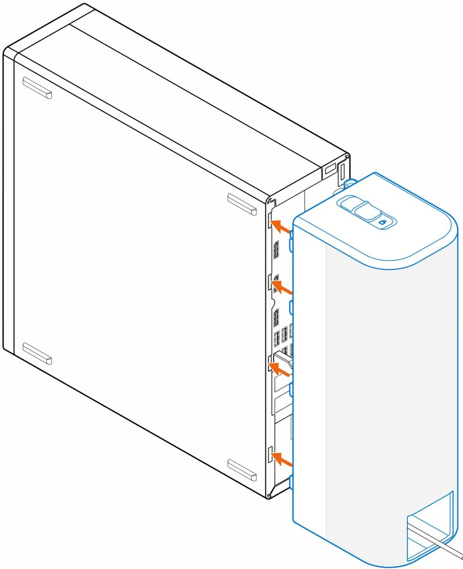
5. Drücken Sie vorsichtig auf die Kabelabdeckung, bis die Kabelabdeckung einrastet.
