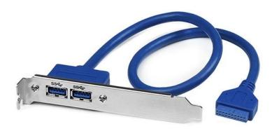
El Bracket de Ranura USB 3.0 A de 2 puertos, USB3SPLATE permite convertir los pines USB del cabezal de tarjeta madre USB 3.0 en 2 puertos USB 3.0 tipo A estándares. El bracket se instala en la parte posterior de una computadora, incorporando así dos puertos USB 3.0 A hembra para una simple conexión a dispositivos periféricos USB.
