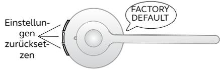
Die Basisstation wird neu gestartet, und die Einstellungen werden auf die Werkseinstellungen zurückgesetzt. Dieser Vorgang wird durch das weiße Akkusymbol
