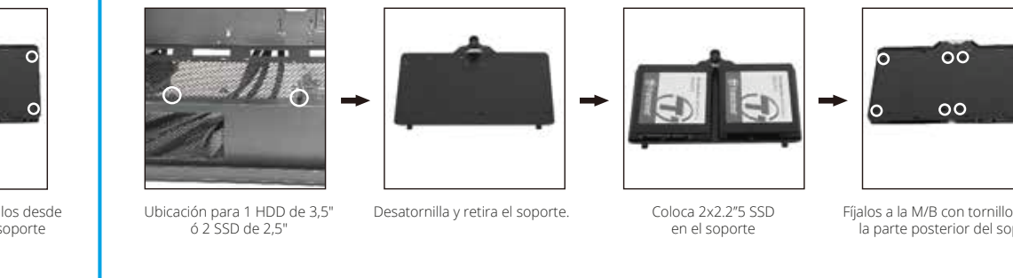
Fíjalos a la M/B con tornillos desde la parte posterior del soporte
