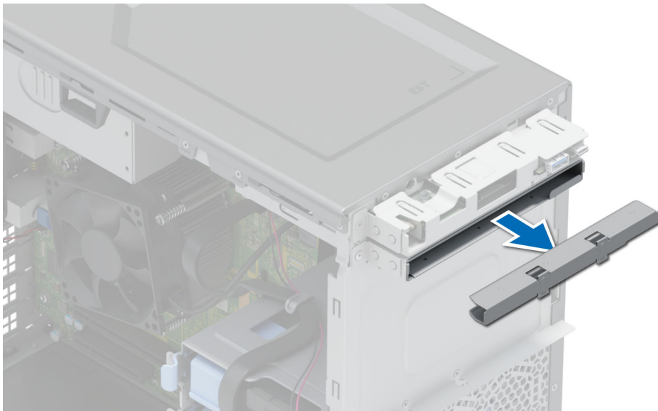
Abbildung 23. Entfernen des Abdeckblechs des optischen Laufwerks aus dem optischen Laufwerksgehäuse
