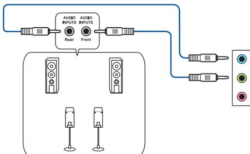
**Conexión de un sistema de altavoces de 5.1 canales**
