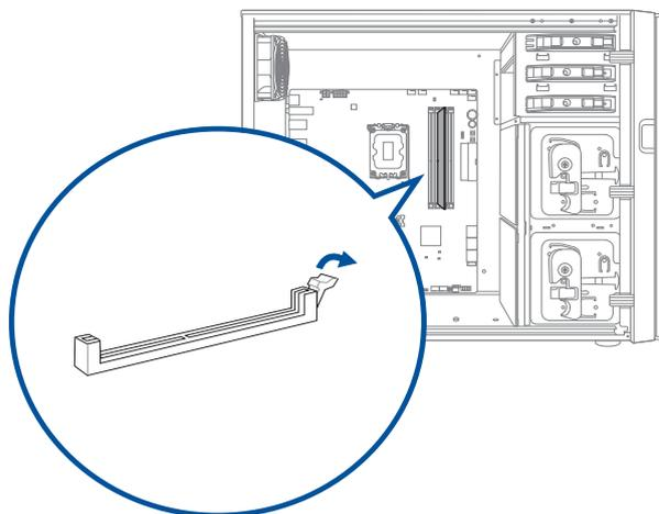
6. Alinee la muesca ubicada en el borde inferior de la memoria DIMM con la marca del zócalo DIMM y, a continuación, inserte firmemente la memoria DIMM en el zócalo hasta que el expulsor encaje en su lugar.
