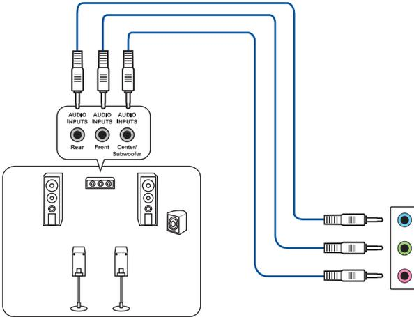
**Conexión de un sistema de altavoces de 7.1 canales**
