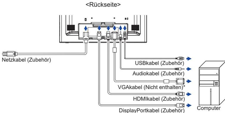
\* Das VGAKabel ist nicht im Lieferumfang enthalten. Wenn ein qualitativ niedriges VGAKabel verwendet wird, kann dies elektromagnetischen Störungen verursachen. Bitte kontaktieren Sie das iiyama Support Center in Ihrem Land, wenn Sie den Monitor über den VGA-Eingang anschließen wollen.
